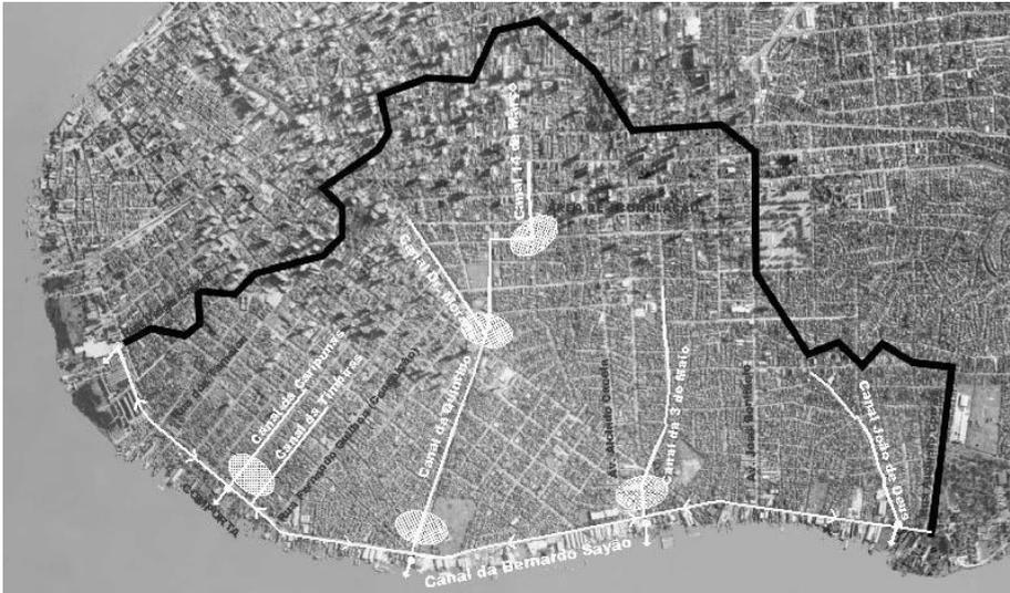
**Figura 1.** Bacia da Estrada Nova: esquema divulgado com as propostas de intervenção para as obras de macrodrenagem, prevendo bacias de retenção e estações de tratamento de esgoto, não executadas.
