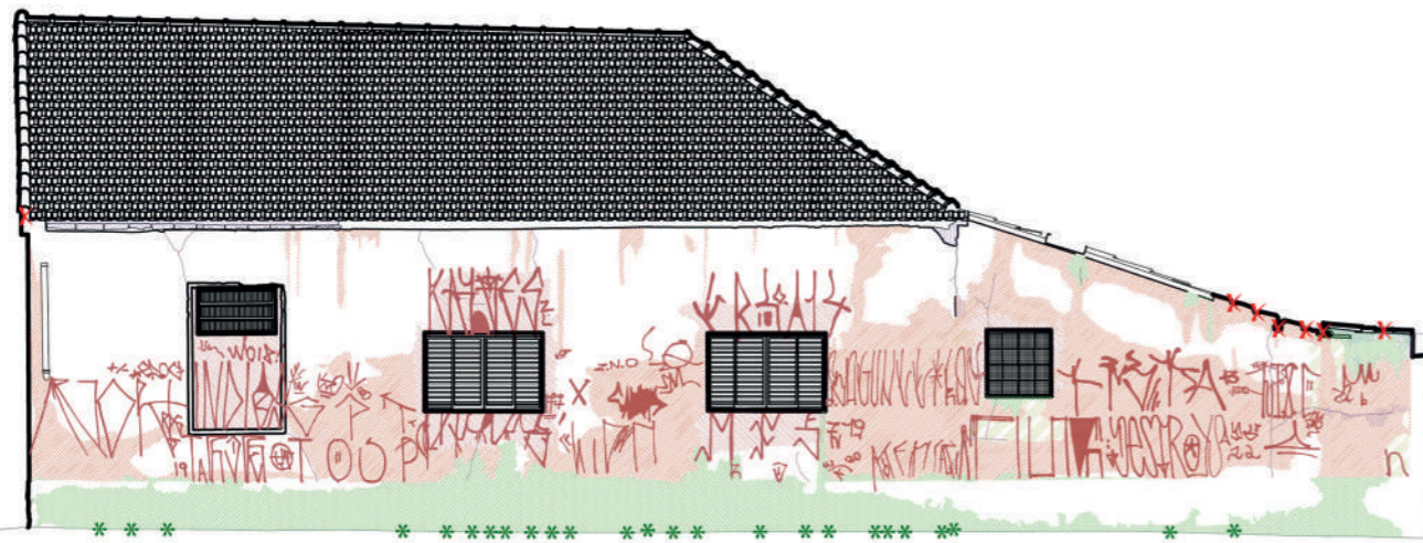
MAPEAMENTO DE DANOS | VISTA 2
