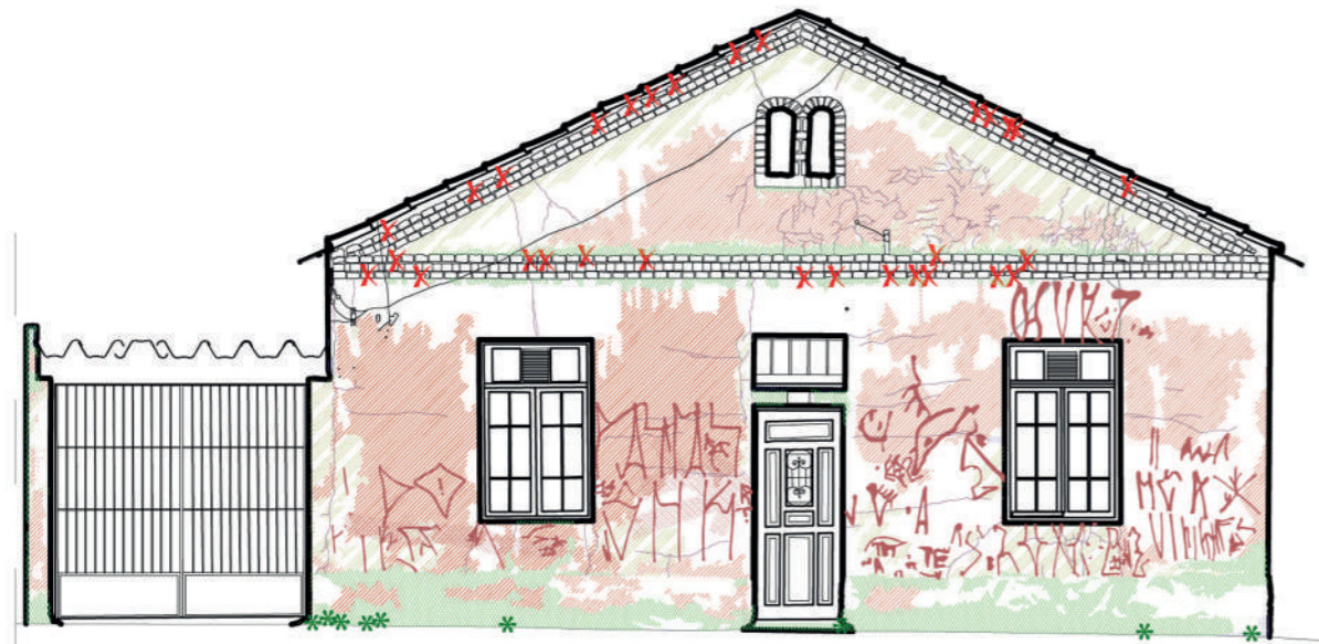
MAPEAMENTO DE DANOS | VISTA 1
